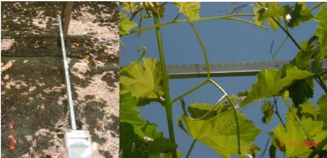
Figura 2 Medición de la radiación fotosintéticamente activa (RFA) bajo el dosel del parronal (izquierda) y sobre el dosel (derecha), utilizando un ceptómetro de barra.
