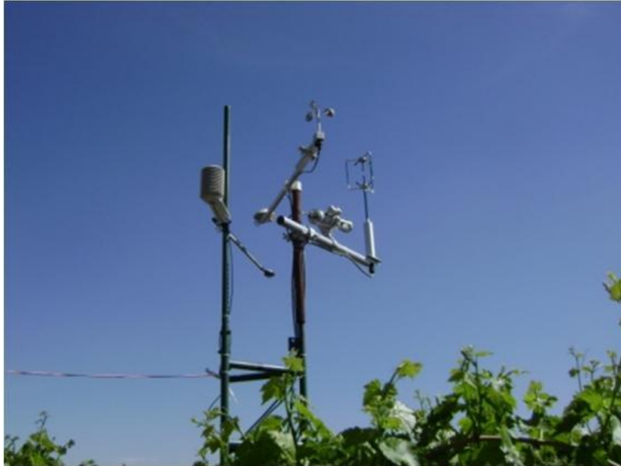
Figura1 . Sistema de flujos turbulentos para determinar la evapotranspiración de un parronal ( Calle Larga, valle de Aconcagua)
